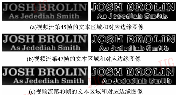
图 3 文本区域在不同帧的边缘特征 Fig. 3 Edge feature of video text in different video frames
